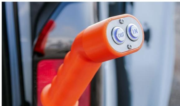
Lediglich **zwei Bedientaster** steuern den **vollautomatischen Ablauf** des Hubladesystems.
